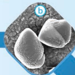
Micrografie SEM di depositi di calcite su superfici da acqua non-magnetizzata (a) e magnetizzata (b).
